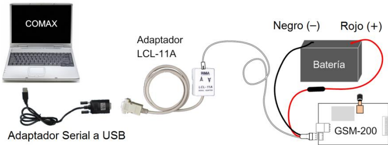
Figura 18. Conexión entre COMAX y GSM-200
